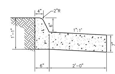
TYPICAL CG-6R 6" CURB & GUTTER (SPILL) DETAILS
